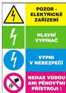
Označení hlavního vypínače elektrické energie.
